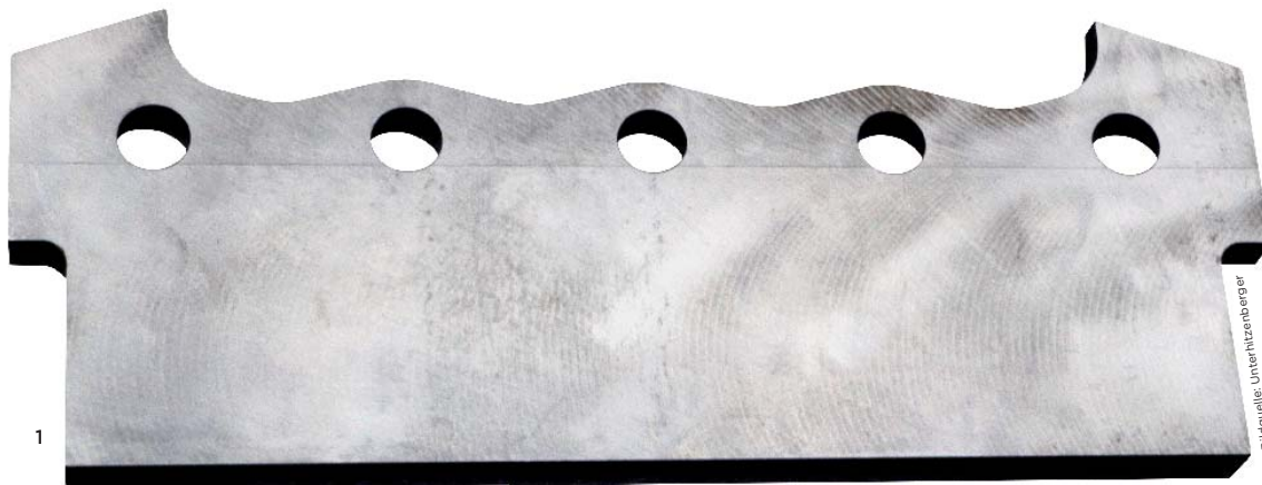
1 Diese überfrästen Platten zum Einpacken von Wellen schneidet AM Maschinenbau auf der Omax.
