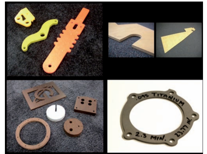
Hochdruckwasserstrahlschneidanlagen können die unterschiedlichsten Werkstoffe bearbeiten
