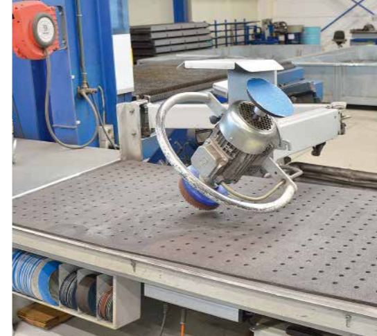
Der Plate Grinder. Eine Entgrattechnik „Marke professioneller Eigenbau“ von Metallbau Ruch.
