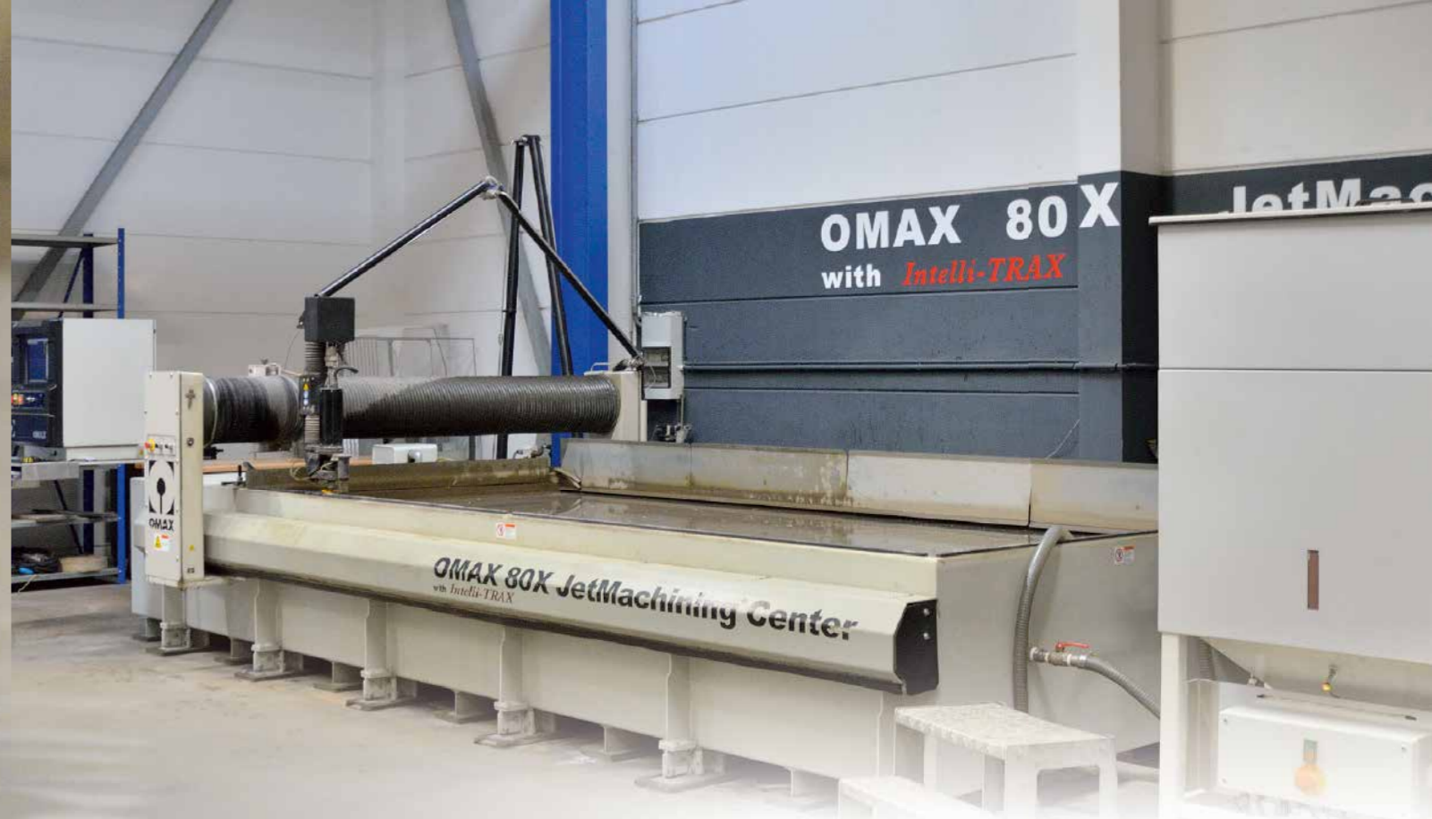
Komplette Omax-Anlage bei Ruch. Abgedeckte Führungen des Intelli-TRAX-Antriebs machen Absicherungen durch Lichtschranken überflüssig.
