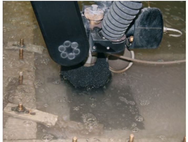
Die von Hohl wasserstrahl-geschnittenen Teile überzeugen durch absolute Passgenauigkeit, woran der besondere Schneidkopf, der eine absolut senkrechte Schnittkante erlaubt, wesentlichen Anteil hat.
