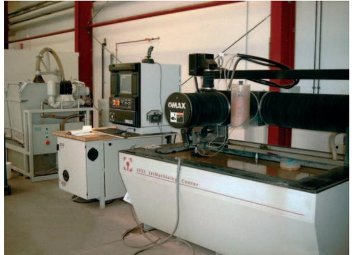
Die JetMachining Center von Omax schneiden komplexe Flachteile aus nahezu jedem Material.
