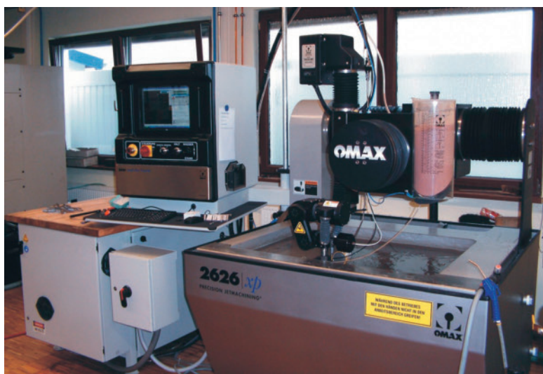
Zuverlässig: Diese Präzisionsanlage (600 mm x 600 mm x 200 mm) für die Herstellung medizintechnischer Teile mit einer Genauigkeit von \pm 0,03 mm steht direkt auf dem Parkettboden
