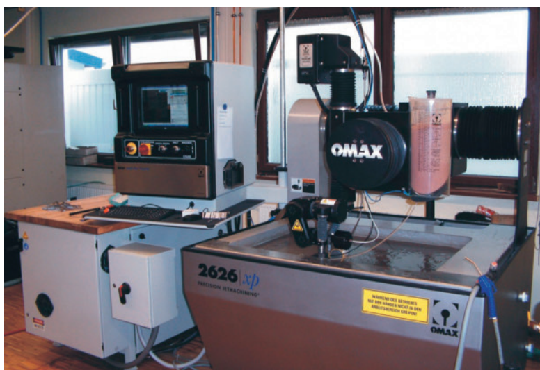
Zuverlässig: Diese Präzisionsanlage (600 mm x 600 mm x 200 mm) für die Herstellung medizintechnischer Teile mit einer Genauigkeit von \pm 0,03 mm steht direkt auf dem Parkettboden
