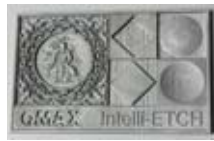
Die Omax 60120 erzeugt auch Reliefs von Logos, Schriften und Bildern mittels Oberflächenabtrag.
