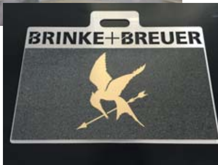
Die Omax 60120 erzeugt auch Reliefs von Logos, Schriften und Bildern mittels Oberflächenabtrag.
