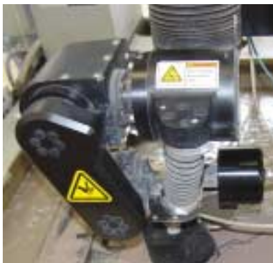
Der Schwenkkopf mit Schneidkonus-Kompensation ermöglicht präzise und gerade Schnitte.
