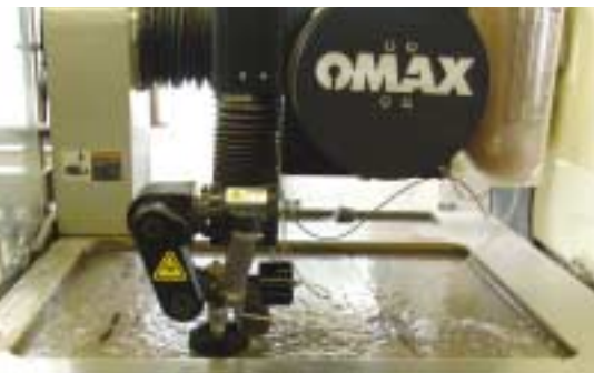
Für trockene Umgebung: Geschnitten wird unter Wasser – sauber im Tauchbad.
