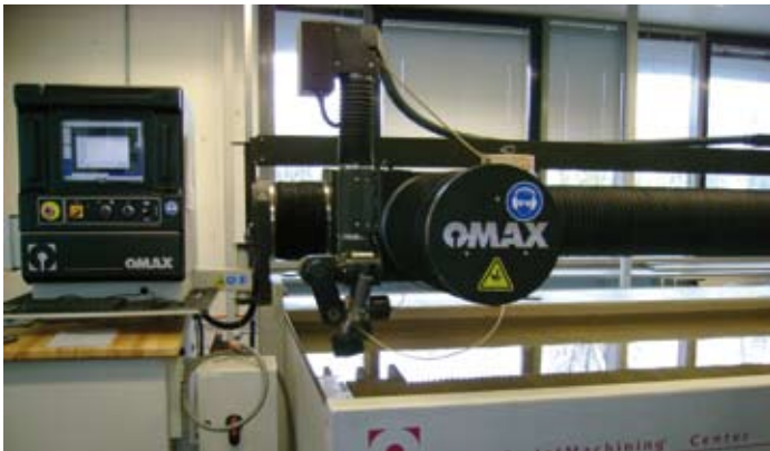
Kühler Schnitt: Die Wasserstrahlanlage Omax 55100 eignet sich fürs präzise Schneiden der verschiedensten Werkstoffe von Aluminium bis hin zu Edelstahl.
