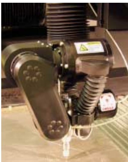
Schwenkkopf: Das Tilt-A-Jet-Verfahren erlaubt ein garantiertes konusfreies Schneiden bis 50 mm Materialstärke; das Schöne dabei: der Bediener muss nur ein paar Parameter eingeben, den Rest erledigt eine Datenbank. Bilder: Omax/fertigung
