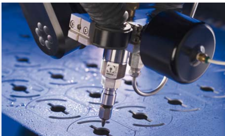
Der Konus des Wasserstrahls wird von der Steuerung automatisch berücksichtigt – so sind exakt lotrechte Schnitte möglich.
