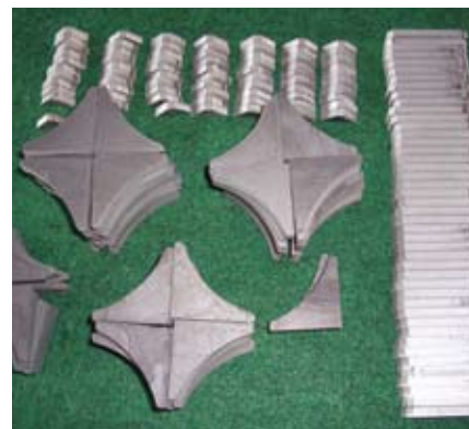
Schneller und exakter Schnitt: Knotenbleche für den Sondermaschinenbau.
