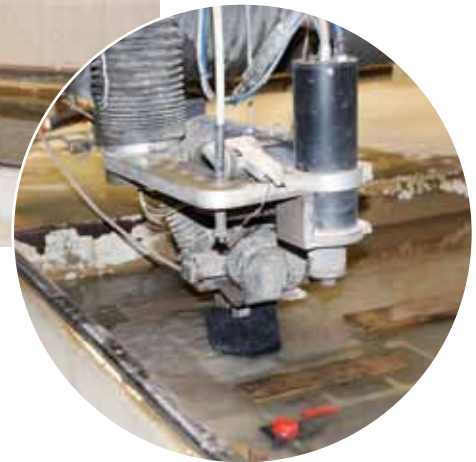
Omax 80X JetMachining-Center bei der Stengelmaier CNC-Fertigung in Laugna. Die Maschine misst 6000 x 2000 mm und ist bestens ausgelastet.
