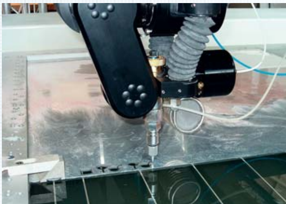
Der Tilt-A-Jet-Schneidkopf gleicht den physikalisch bedingten Konuseffekt beim Wasserstrahlschneiden aus und ermöglicht präzise Kanten zum Beispiel auch bei Kurvschnitten Bilder: Innomax
