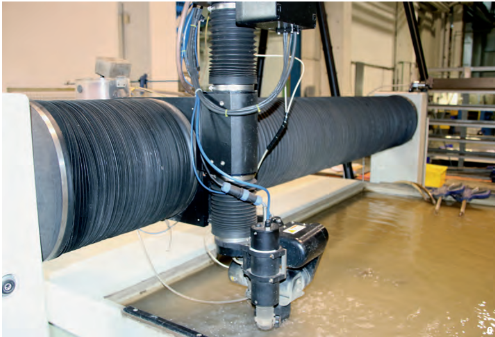
4 Der 3D-Kopf ist \pm 9 Grad schwenkbar. 5 Das Maschinenbett fasst zwei mal vier Meter große Bleche. 6 Auch im Detail durchdacht: Runde Balgen sind leichter zu reinigen.
