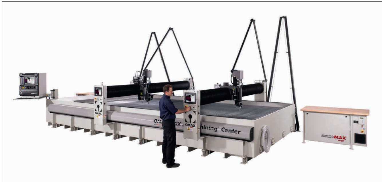
„Jet Machining Center“ schneiden nach CAD-Vorgabe komplexe Flachteile aus nahezu jedem Material. Dies können leitende und nicht leitende Metalle sein, Kunst- und andere Werkstoffe. © Innomax
