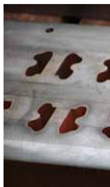
Sehr exakt und mit kleinen Radien lassen sich auch komplexe Durchbrüche in den Platten erstellen.
