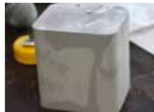
Die Oberfläche wirkt wie sandgestrahlt – meist ist keine Nacharbeit mehr notwendig.
