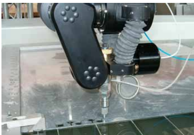
Der Präzisionsschneidkopf ›Tilt-A-Jet‹ ermöglicht es, winklige Teile mit einer Genauigkeit von \pm 0,02 Millimeter herzustellen.
