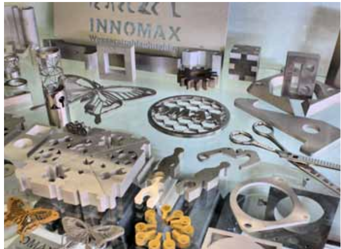
Glas, Aluminium, Kunststoff, Keramik oder gehärteter Stahl – es gibt nahezu kein Material, das sich nicht per Wasserstrahl perfekt bearbeiten lässt.
