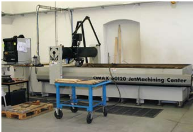
Saubere Sache: Die MASchine arbeitet dank Unterwasserschnitt leise und ohne Verschmutzungen.
