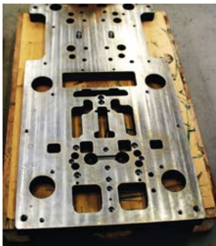
Bei den Platten werden sowohl Innen- als auch Außenkonturen bis auf wenige Ausnahmen auf dem Omax 60120 JetMachining Center erstellt.
