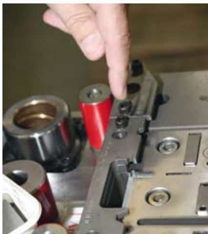
Neben den Blechzuschnitten werden auch Komponenten für Werkzeuge komplett einbaufertig auf der Omax-Anlage gefertigt.
