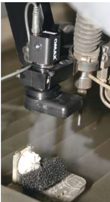
Per Kamera lässt sich die Omax-Anlage exakt einrichten.
