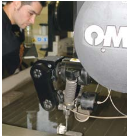
Bei Access werden die Werkstücke auf der Omax-Anlage schonend per Wasserstrahl vom Gießsystem getrennt.
