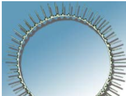
Auch die empfindlichen Ventilstößel können schonend per Wasserstrahl vom Gießkranz getrennt werden.
