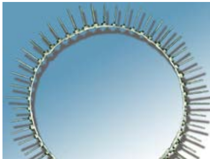
Auch die empfindlichen Ventilstößel können schonend per Wasserstrahl vom Gießkranz getrennt werden.
