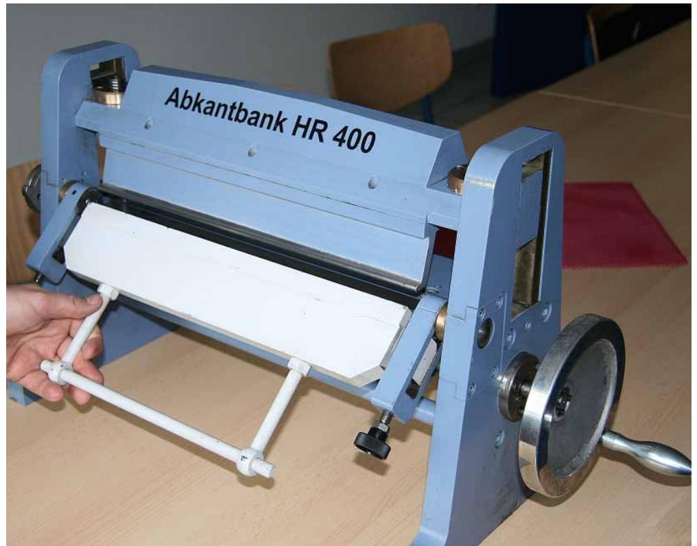
Diese in norddeutschen Ausbildungswerkstätten verbreitete kleine Abkantbank ist bis auf die Normteile und die Gewinde bei HR komplett mit Wasserstrahl geschnitten worden – ohne Nacharbeit.
