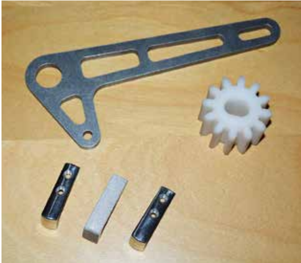
4 Klassische Halbzeuge der Söruper Metall-experten, hergestellt auf der Omax-Anlage; das Tagesgeschäft bei AMB bietet mannigfaltige Anwendungsgebiete für eine flexible Vorfertigung mithilfe des Wasserstrahlschneidens (Bild: Hanser)
