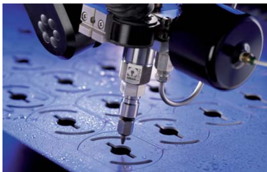
Omax-Schwenkkopf Tilt-A-Jet: Automatische Konuskorrektur mittels Schwenkkopf.
