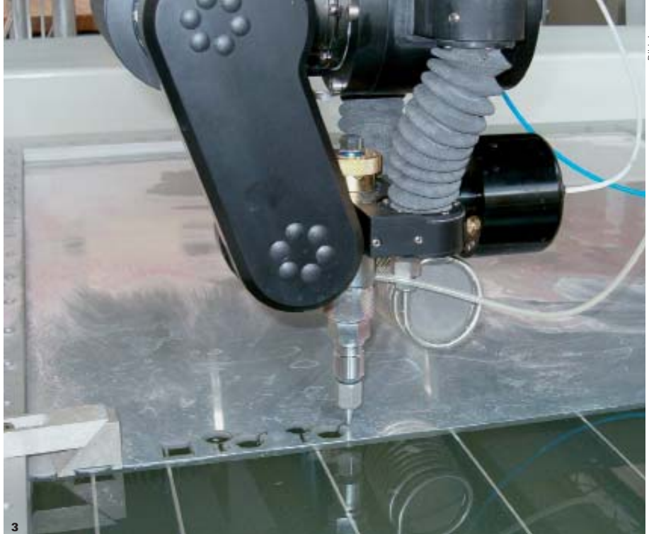
1 Ersatzkettenrad mit Passung für Ständerbohrmaschine aus Hardox 500. 2 Antriebsstern aus Hardox 500. 3 Der Präzisionsschneidkopf ›Tilt-A-Jet‹ liefert Ergebnisse bis \pm 0,05 Millimeter, bei Materialstärken bis 30 Millimeter sogar bis \pm 0,02 Millimeter.
