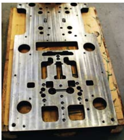
Bei den Platten werden sowohl Innen- als auch Außenkonturen bis auf wenige Ausnahmen auf dem Omax 60120 JetMachining Center erstellt.
