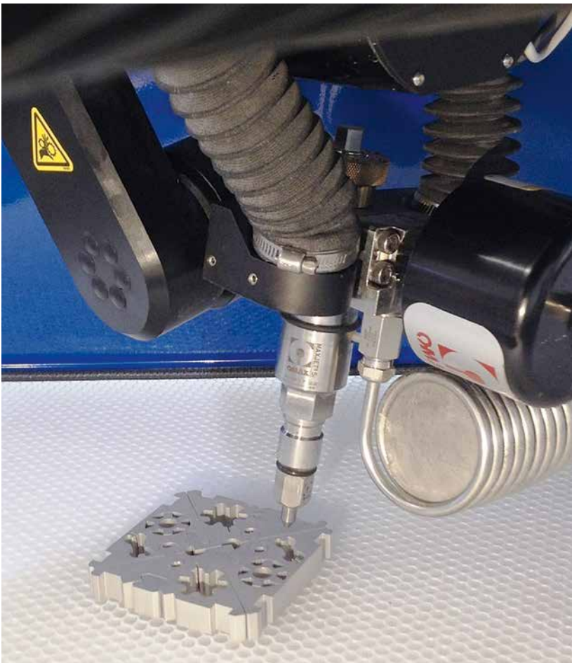
Der Präzisionsschwenkkopf Tilt-A-Jet und die Kompensationsalgorithmen der Omax-Software kompensieren Winkelfehler im Schnittspalt bis auf +/- 20 µm.
