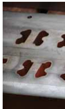
Sehr exakt und mit kleinen Radien lassen sich auch komplexe Durchbrüche in den Platten erstellen.
