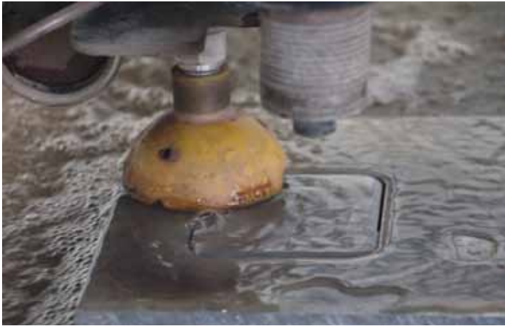
Dank Unterschnitt gibt es keine Emissionen. Heutige Wasserstrahlanlagen fügen sich harmonisch ins Fertigungsumfeld ein.
