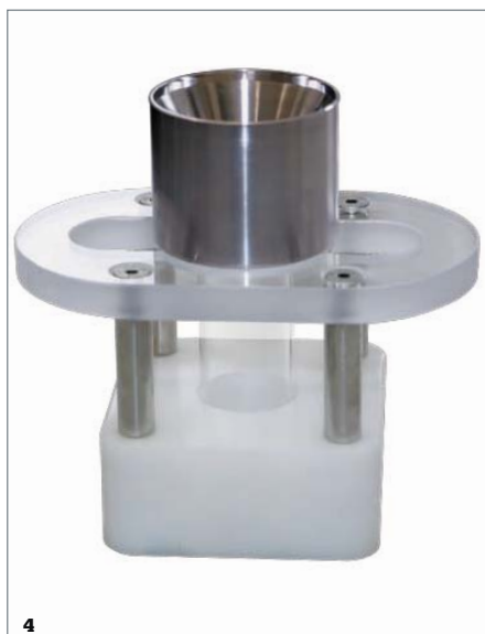
1 Das Tiefsee-Forschungsgerät »Launcher« wird vom »Polarstern« zu Wasser gelassen. 2 Der »Launcher« macht Aufnahmen vom Meeresgrund. 3 In der technischen Werkstatt in Bremerhaven wird die 500 Kilogramm schwere Stahlkonstruktion für die Tiefseeforschung gefertigt. 4 Ein gutes Beispiel dafür, wie genau auch Kunststoffe mit der »Omax 2626« geschnitten werden können, ist dieser Sedimentteiler.
